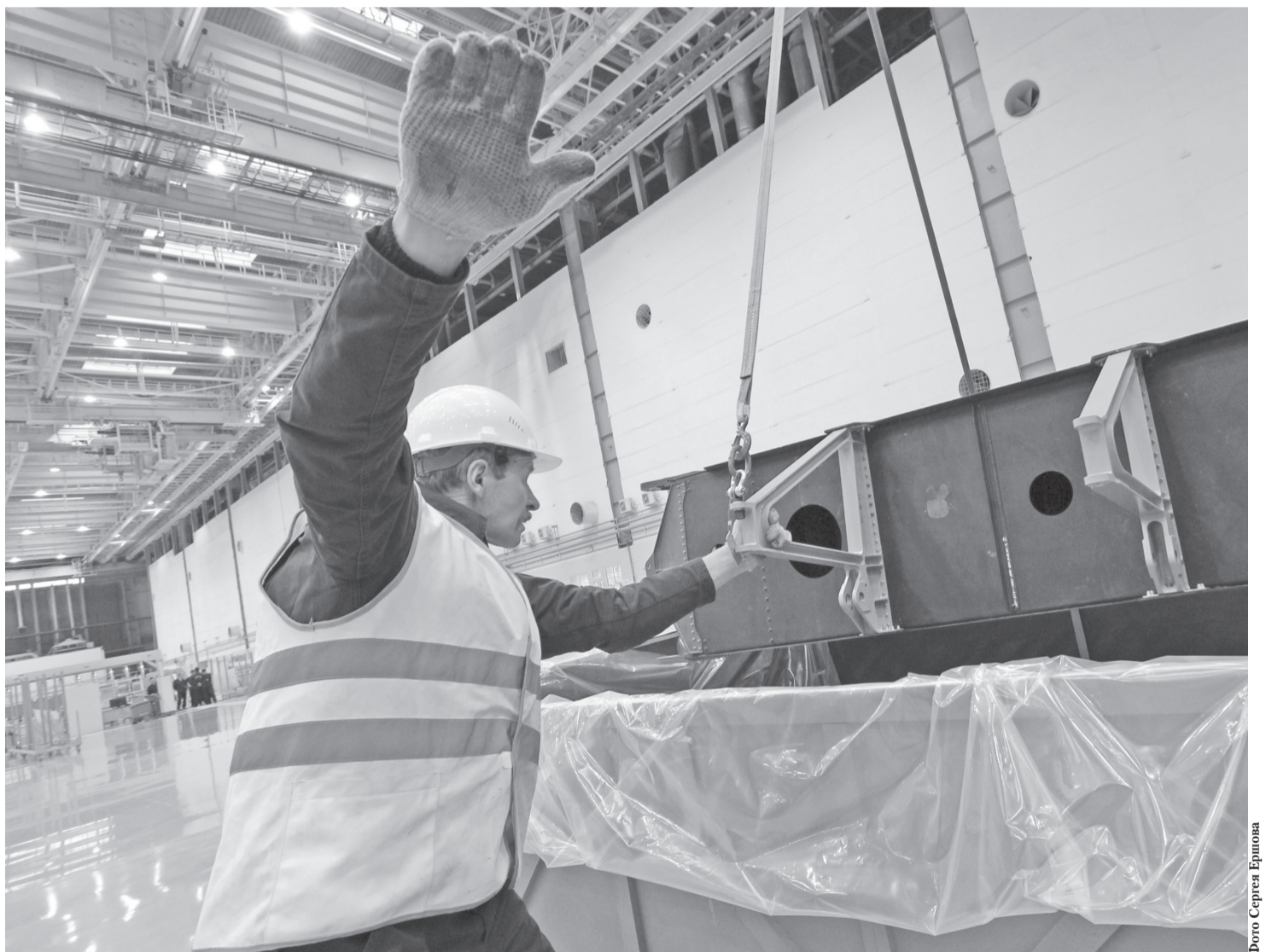
«Авиастар-СП». 18 декабря 2014 года. На стендовые испытания в ЦАГИ отправляется первый, собранный в России из композитных материалов - и сразу из композитных материалов отечественного производства - кессон киля
